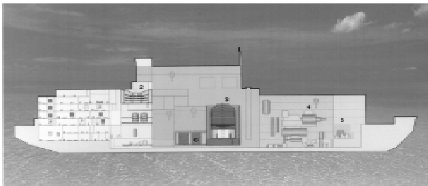
Рис.1. Схема плавучей атомной станции (продольный разрез по оси судна)
